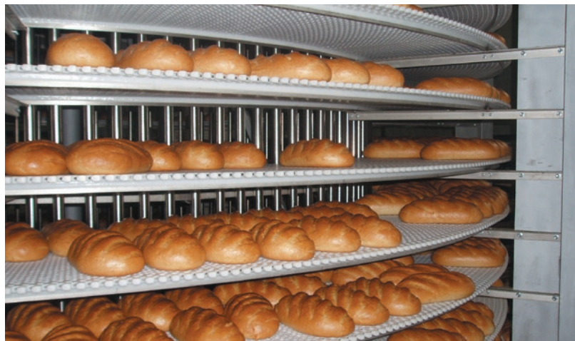
В зависимости от массы, формы, состава и других параметров продукция может охлаждаться за счет процессов естественной конвекции или в искусственно создаваемой среде
