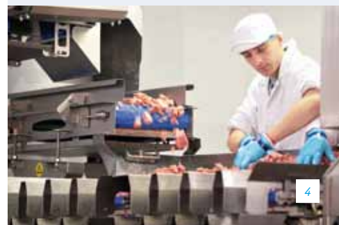
4. Бункеры со скребковыми створками обеспечивают непрерывный поток даже для самого липкого продукта.
