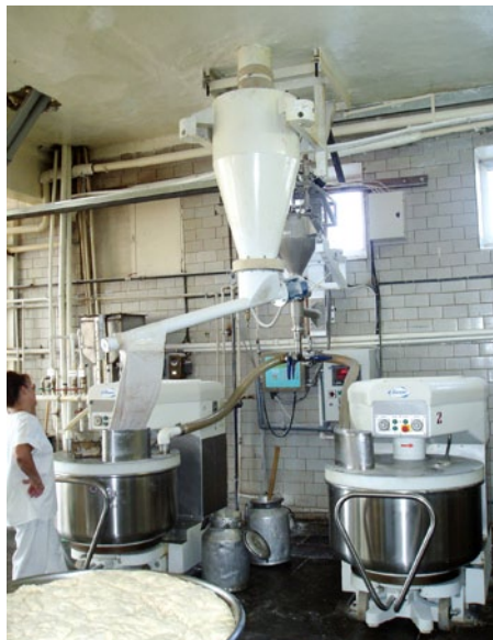
Дозаторы сыпучих и жидких ингредиентов производства «АГРО-3» на Егорьевском хлебокомбинате
