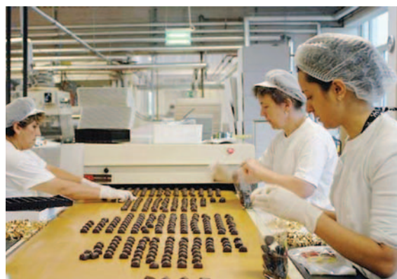
После охлаждения корпуса температурой 24-26°C направляются в глазировочную машину, затем в охлаждающий шкаф, после чего они поступают на завертку и упаковку.
