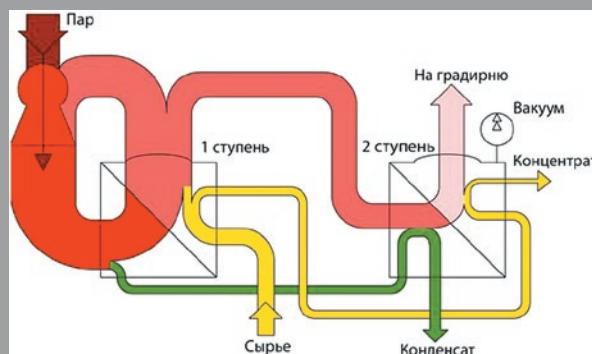
Рис. 2 Схема установки TVR
