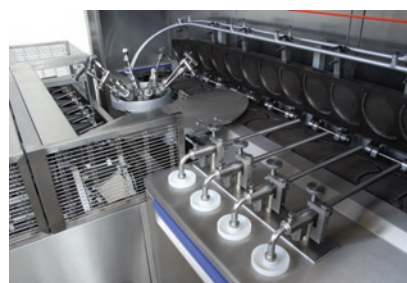
Заливочное устройство для теста и подача на формирование вафельного рожка
