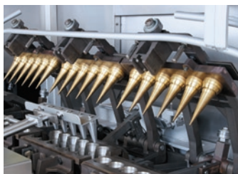
Вафельницы с выталкивающим устройством литых вафельных форм
