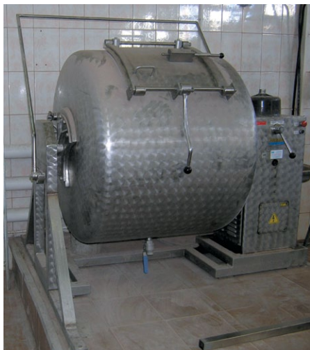
Фото 1. Маслообразователь периодического действия
