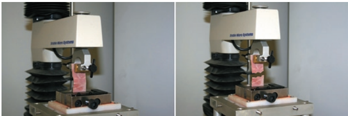
Фото 4. Испытание на разрыв на анализаторе текстуры Texture Analyser TA.TX2 (Stable Micro System)
