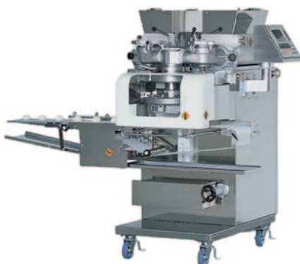
Разработчики объединили в KN-550 все технические достижения двух предыдущих модификаций, а также создали дополнительные преимущества. Производительность машины увеличилась до 90 изделий в минуту
