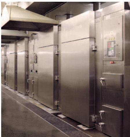
Термическое отделение на базе приобретенных камер Mauting
