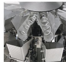
» Автоматические высокопроизводительные весы со шнековой подачей
