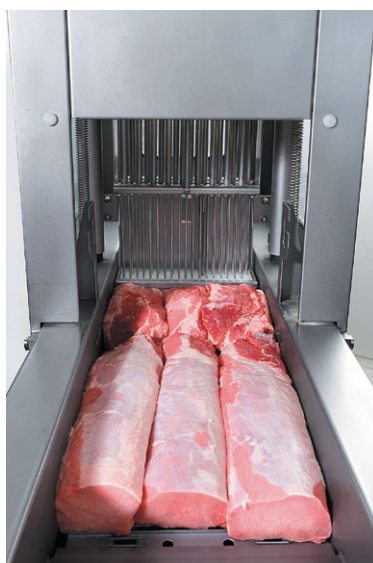
Технология инъектирования эмульсией от Inject Star® – это новая веха в переработке мяса. В отличие от традиционного посола эмульсия состоит не только из воды, соли и специй, в нее дополнительно вводится животный белок в форме мелких мясных обрезков.
