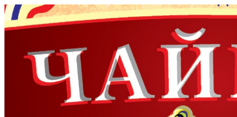
Рис. 2. Неприводка. Уменьшить влияние неприводки на оригинал-макет – одна из основных задач специалиста допечатной подготовки.
